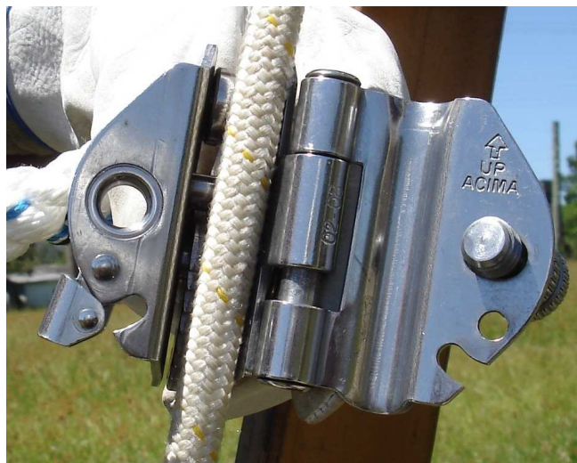
Figura 33 – Instalação do trava-quedas na linha de vida
