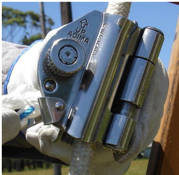
Figura 35 – Fechamento e travamento do trava-quadras
