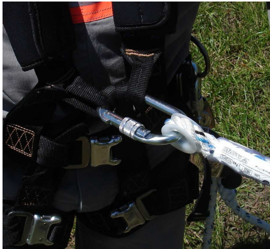
Figura 34 – Instalação do trava-quadras no cinto paraquedista
