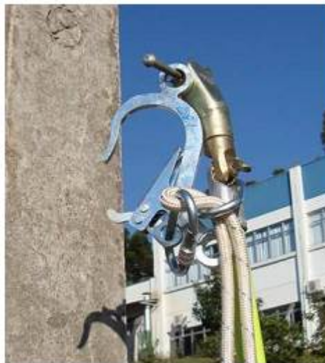
Figura 28 – Instalação do gancho no cabeçote da vara de manobra
