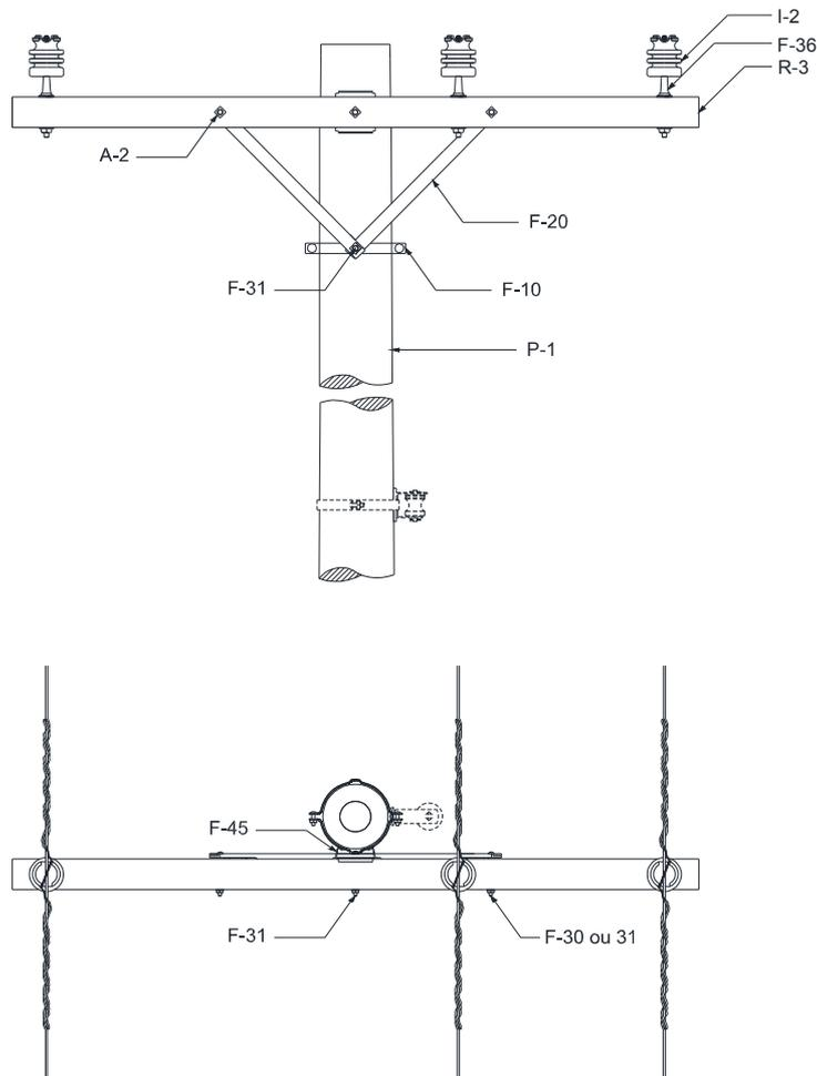
Figura 37 – Estrutura N1 – Poste de Seção Circular
