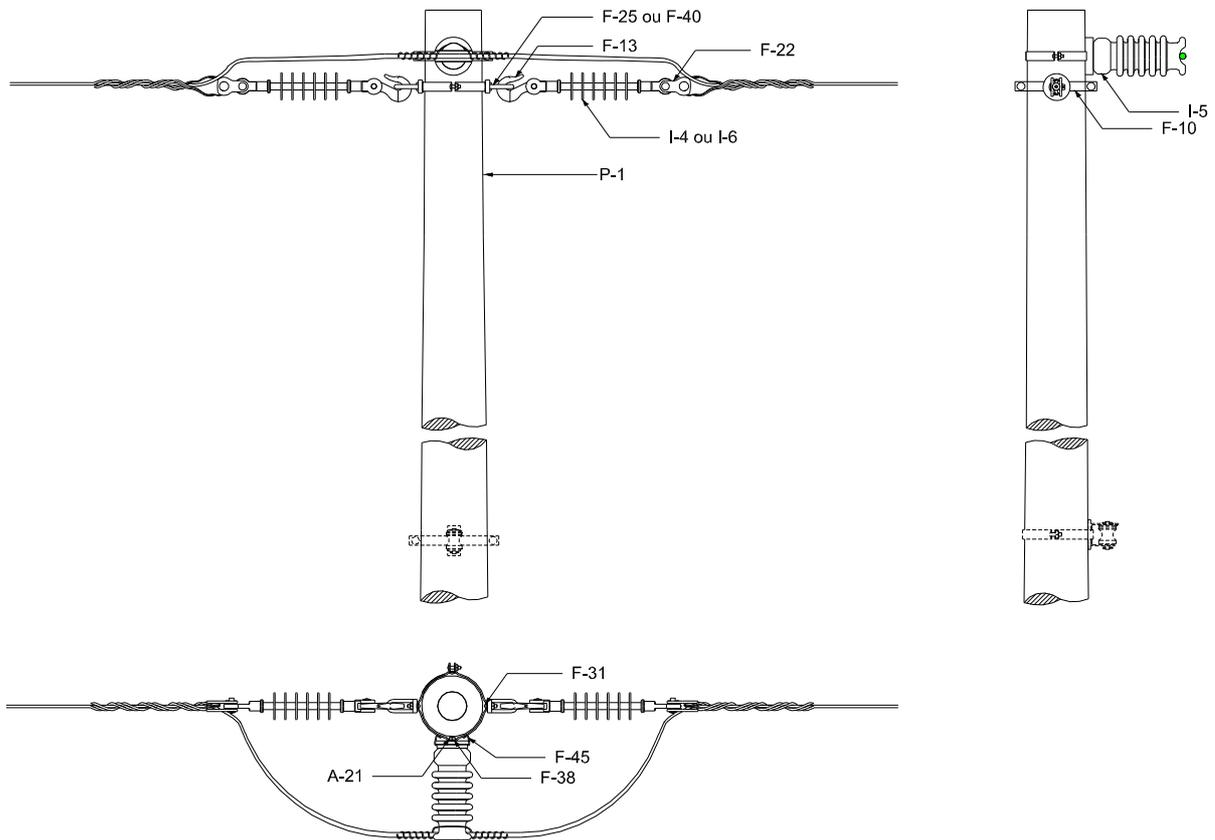
Figura 74 – Estrutura UP4 – Poste de Seção Circular
