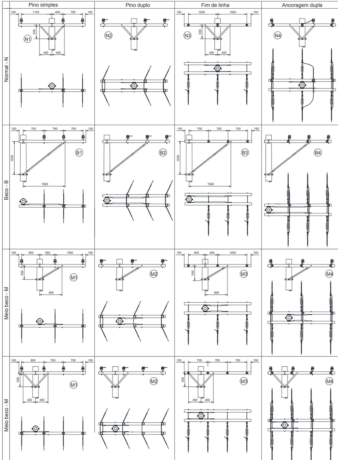
Figura 22 – Afastamentos de condutores – Cruzeta de 2400mm
