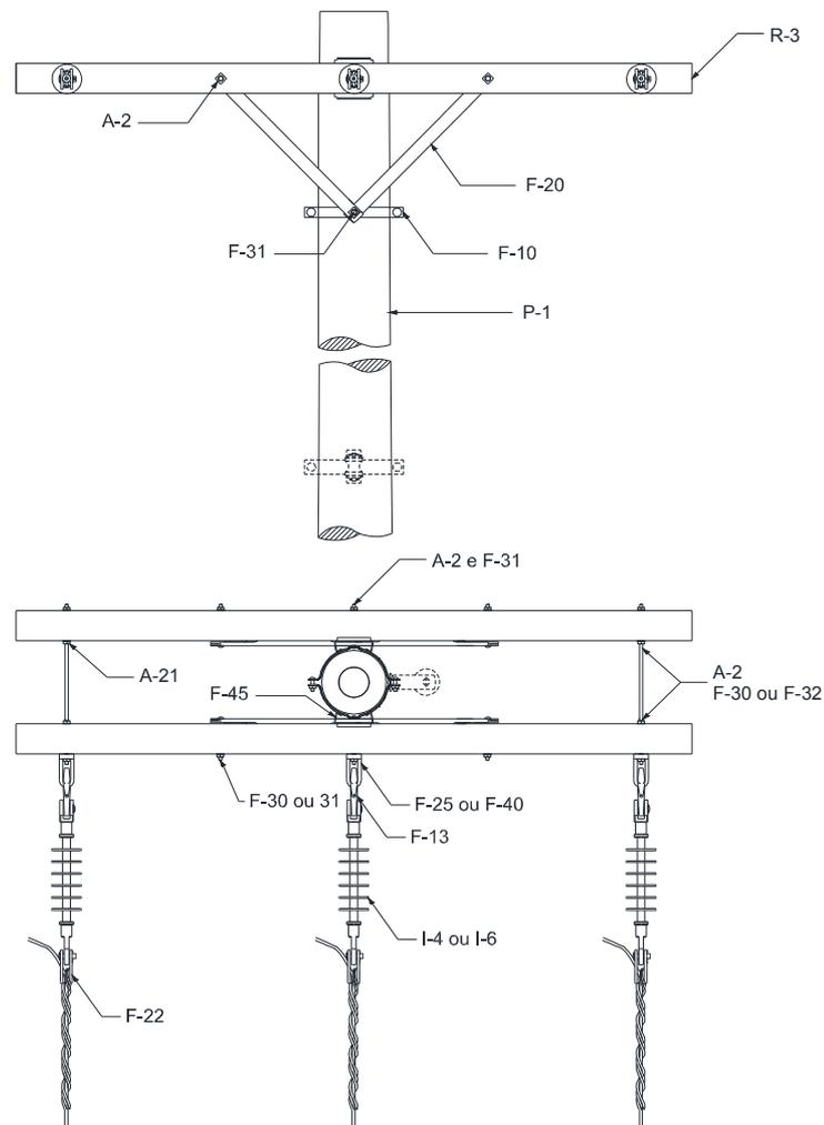
Figura 41 – Estrutura N3 – Poste de Seção Circular
