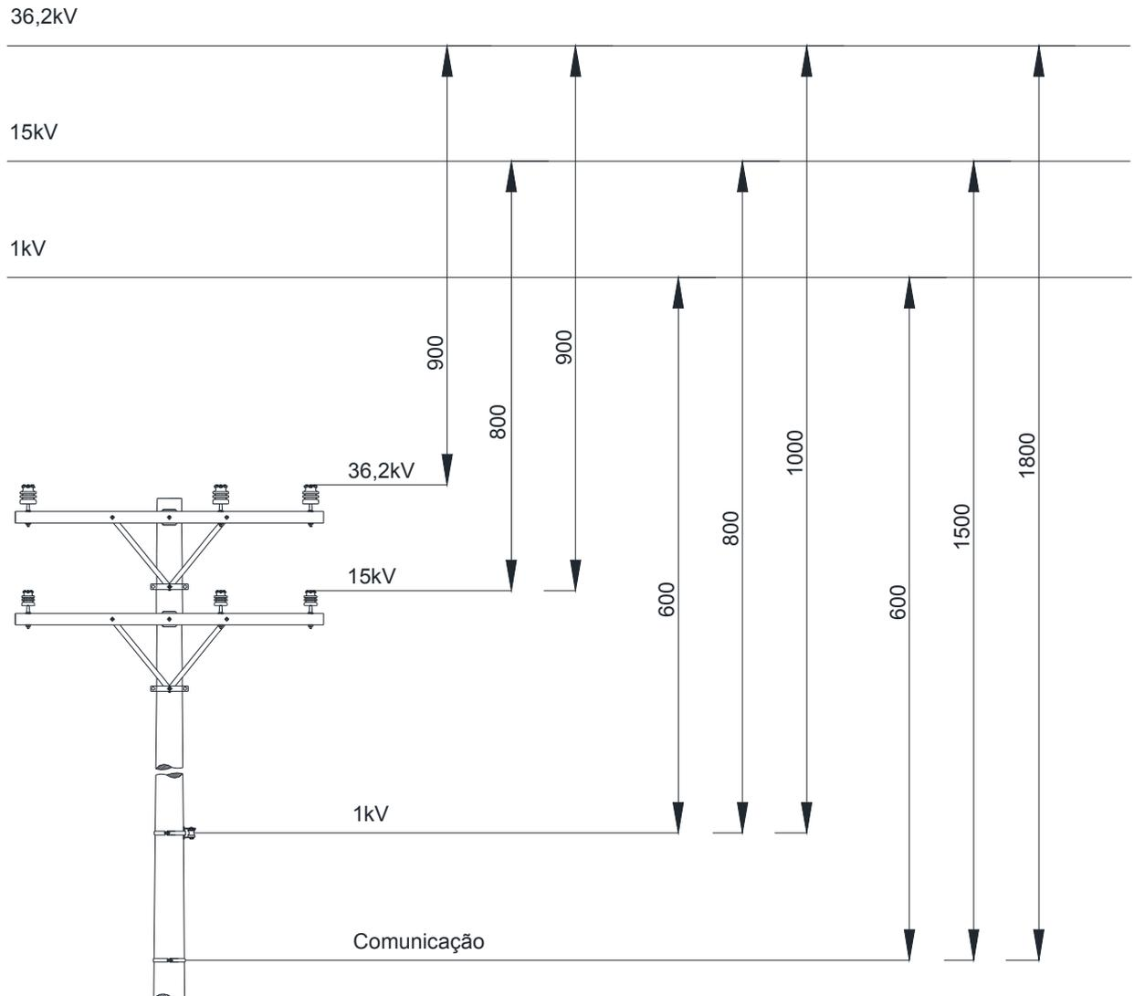
Figura 3 – Afastamentos mínimos – Circuitos diferentes
