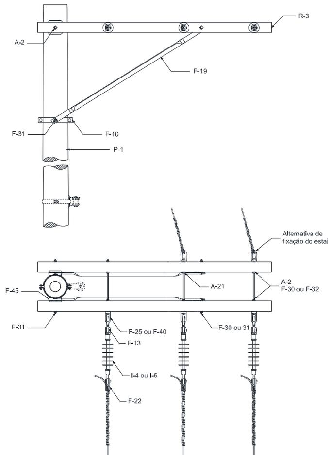
Figura 61 – Estrutura B3 – Poste de Seção Circular
