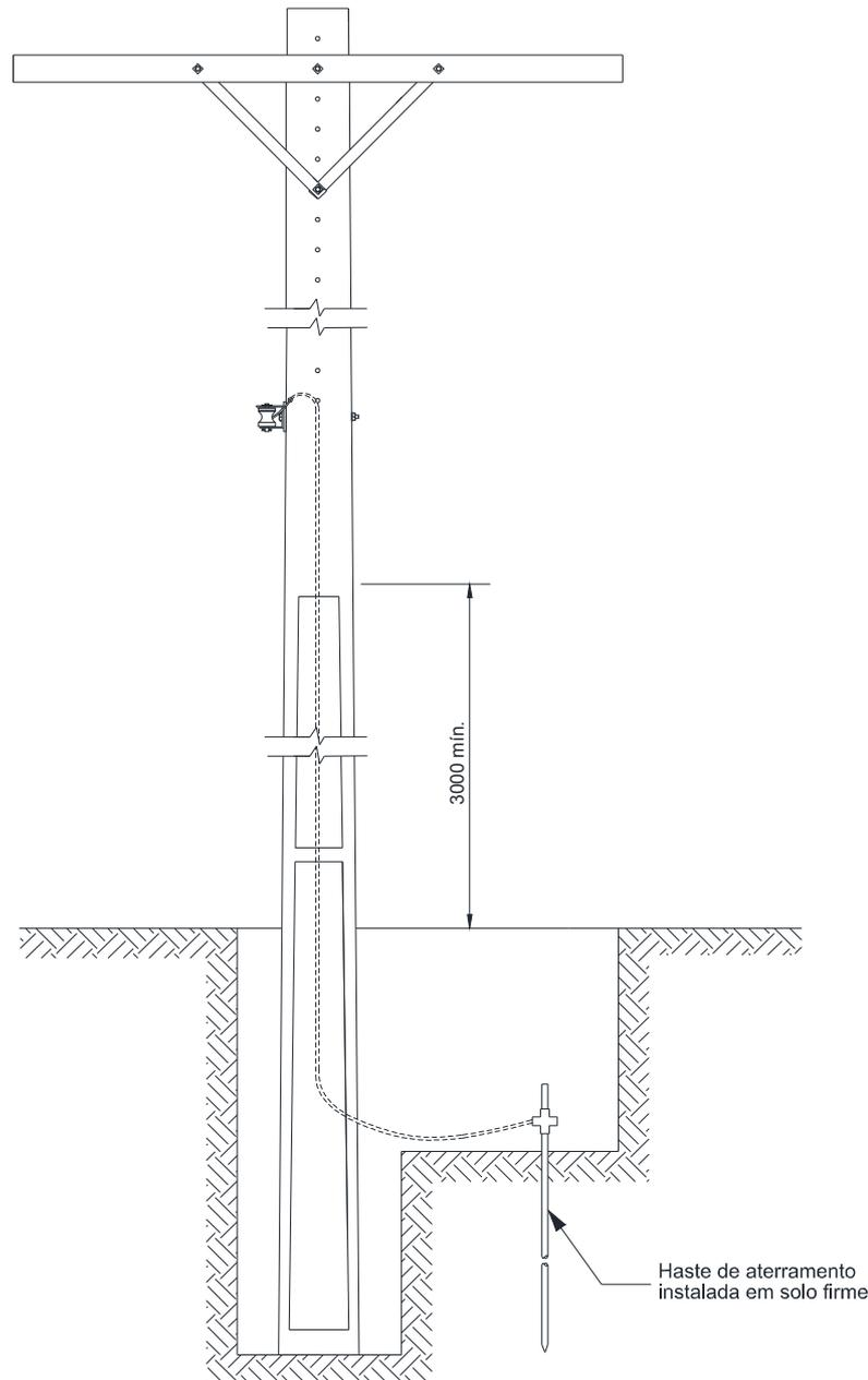
Figura 135 – Aterramento de rede secundária – Poste de concreto
