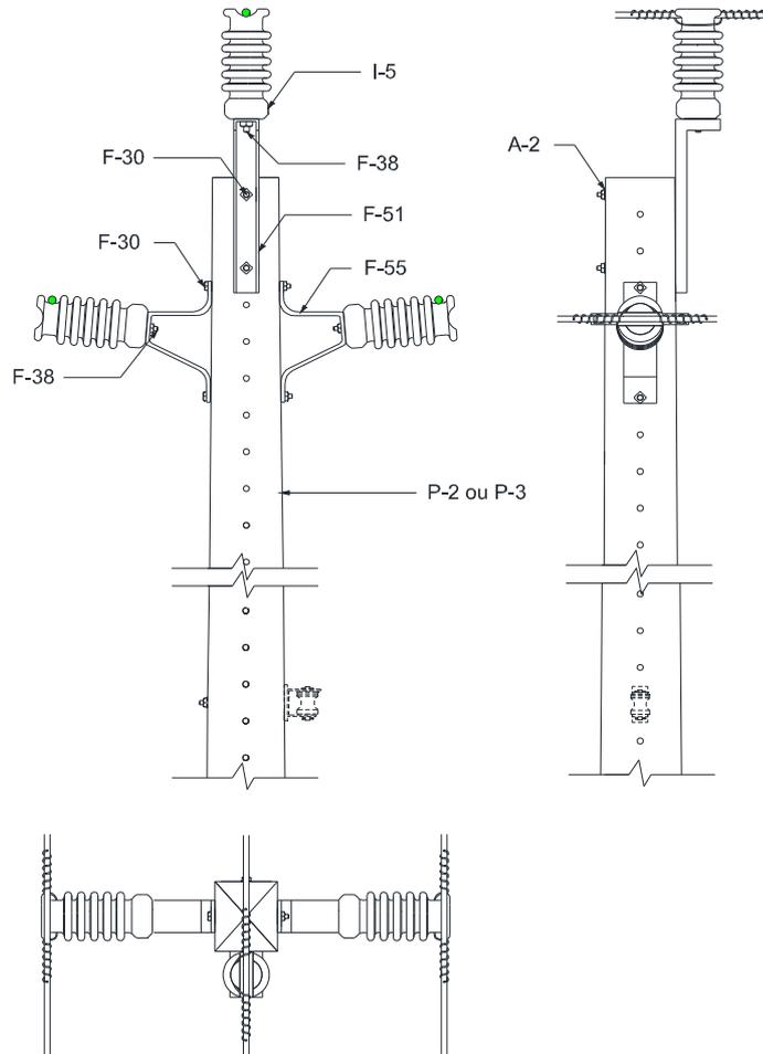
Figura 85 – Estrutura TP – Poste de seção DT ou madeira
