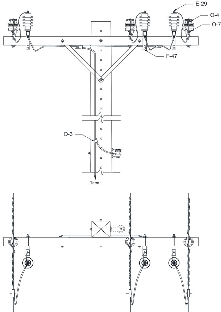
Figura 110 – Instalação de equipamento – Para-raios – Estrutura trifásica
