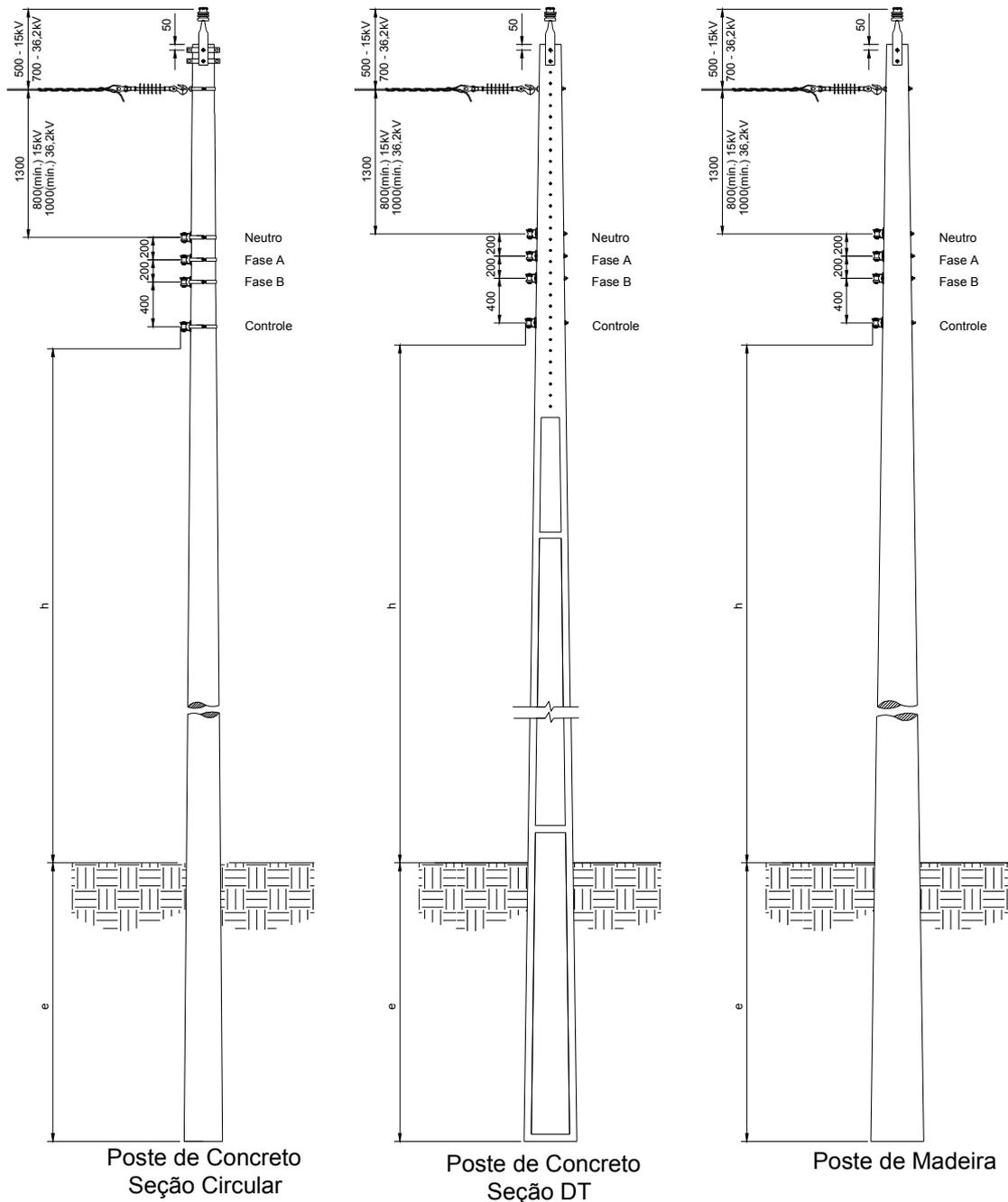
Figura 6 – Afastamentos mínimos – Estrutura monofásica tangente com derivação
