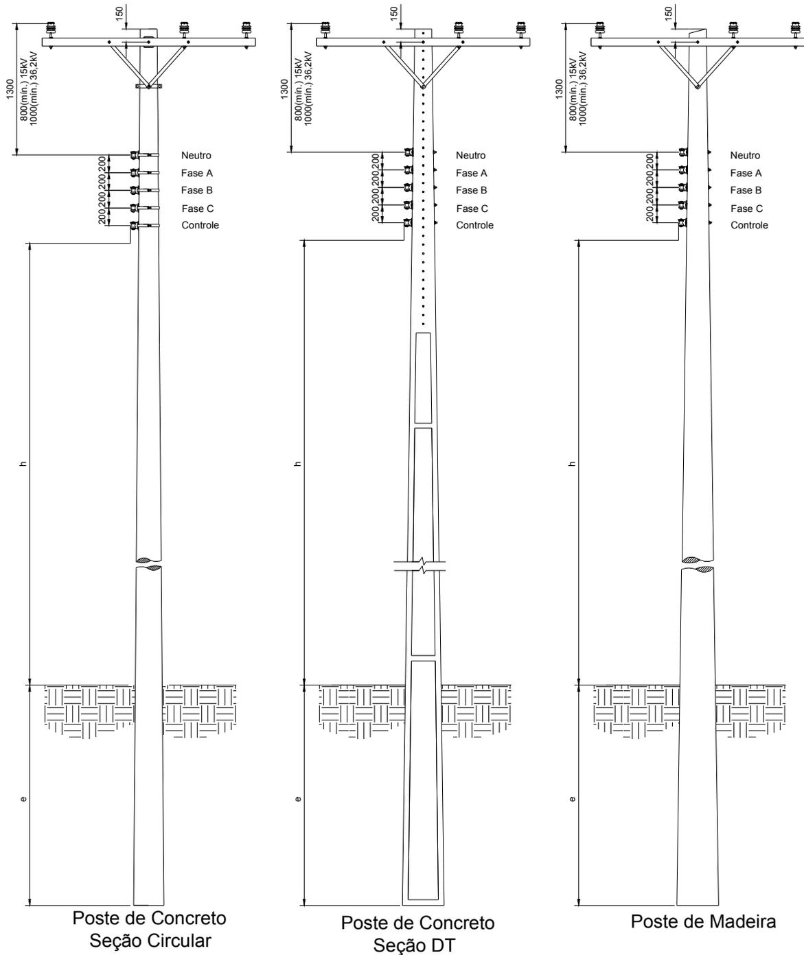
Figura 7 – Afastamentos mínimos – Estruturas trifásicas tangentes
