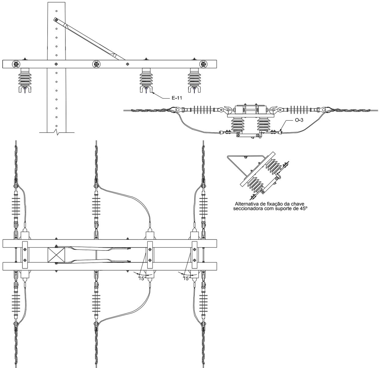
Figura 103 – Instalação de equipamento – Chave seccionadora 1º nível – Estrutura trifásica M4 – Alternativa
