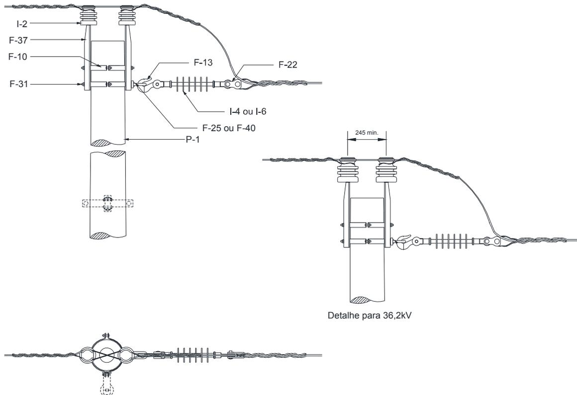
Figura 32 – Estrutura U3-2 – Poste de Seção Circular
