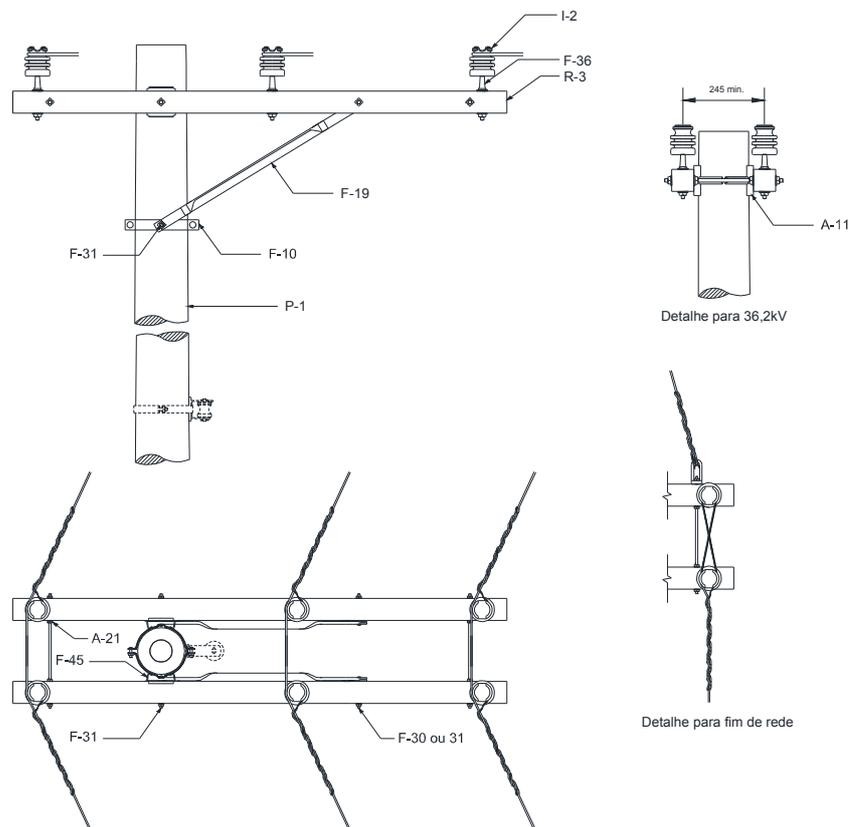
Figura 49 – Estrutura M2 – Poste de Seção Circular
