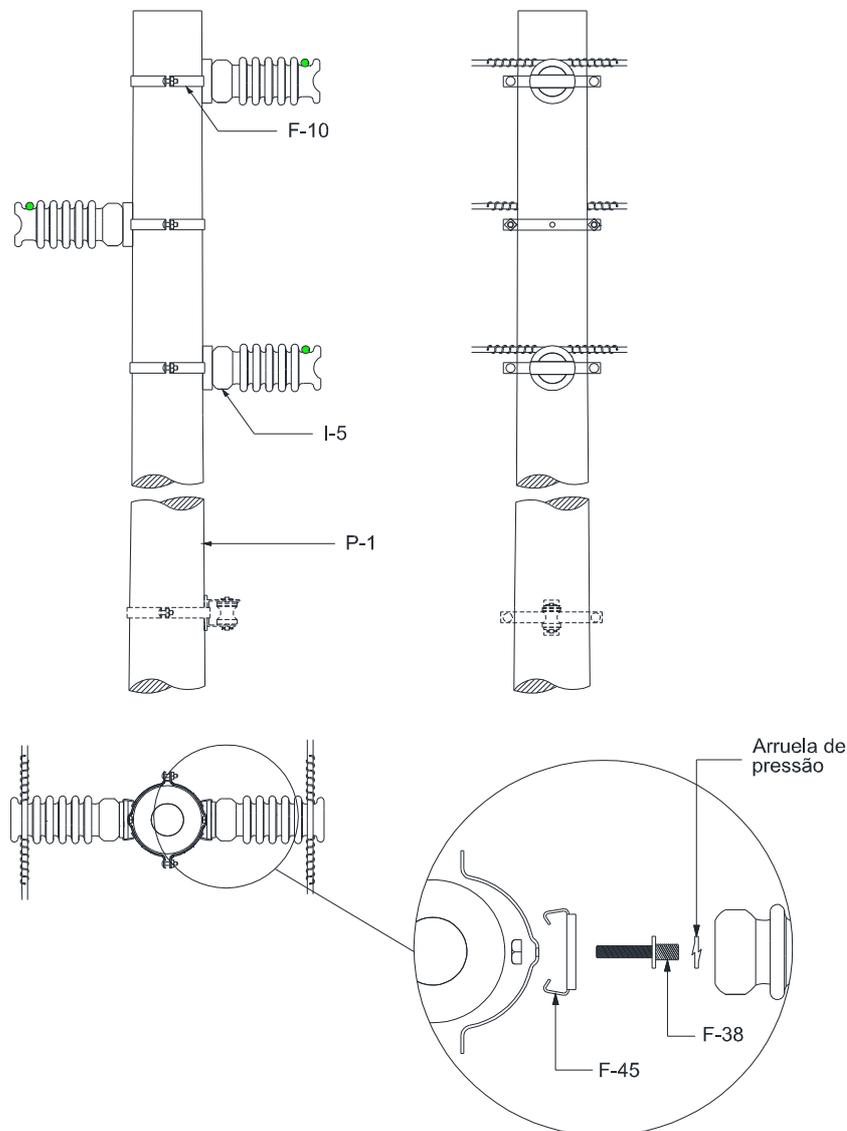
Figura 76 – Estrutura P1 – Poste de Seção Circular
