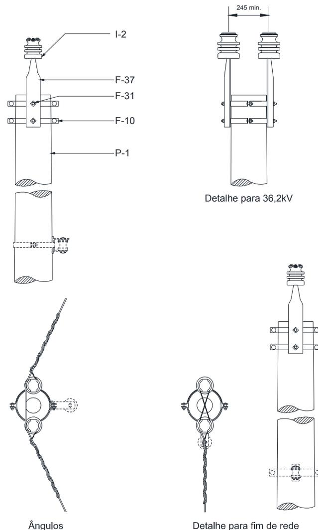
Figura 28 – Estrutura U2 – Poste de Seção Circular
