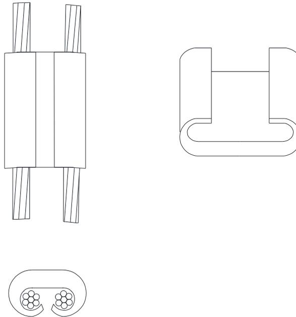
Figura 158 – Conexões – Conector de compressão tipo “C”
