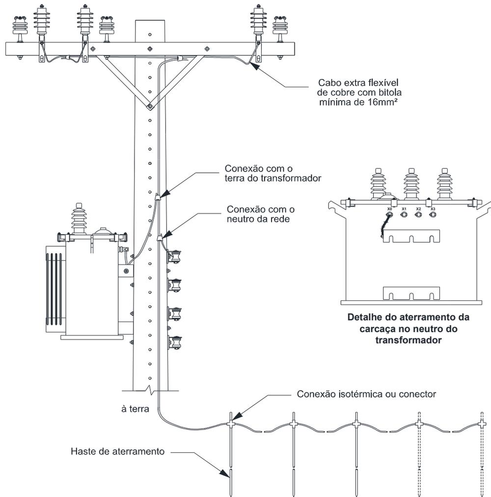
Figura 134 – Aterramento de equipamento
