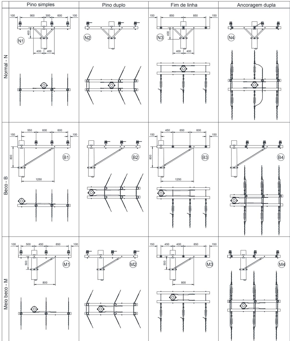
Figura 21 – Afastamentos de condutores – Cruzeta de 2000mm
