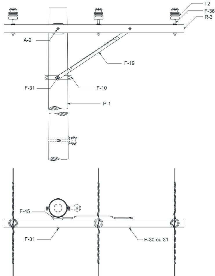
Figura 47 – Estrutura M1 – Poste de Seção Circular
