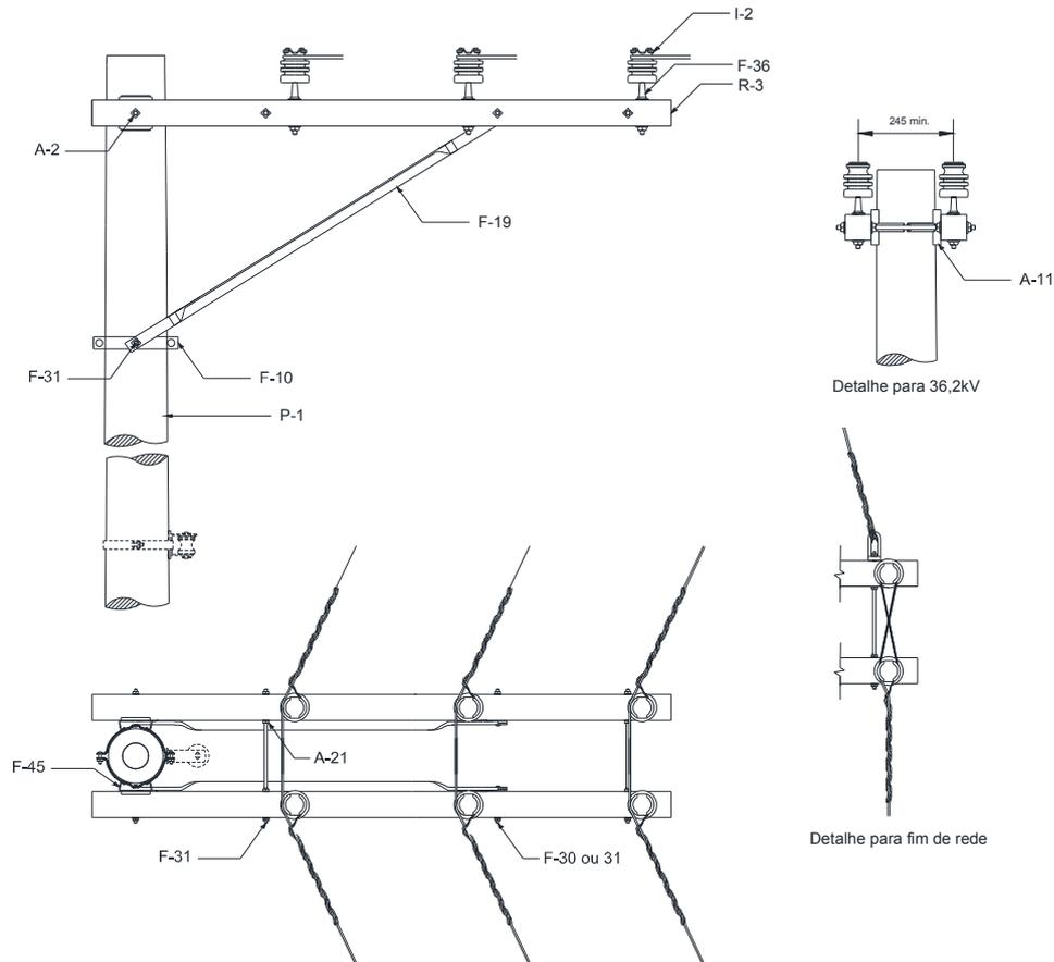
Figura 59 – Estrutura B2 – Poste de Seção Circular
