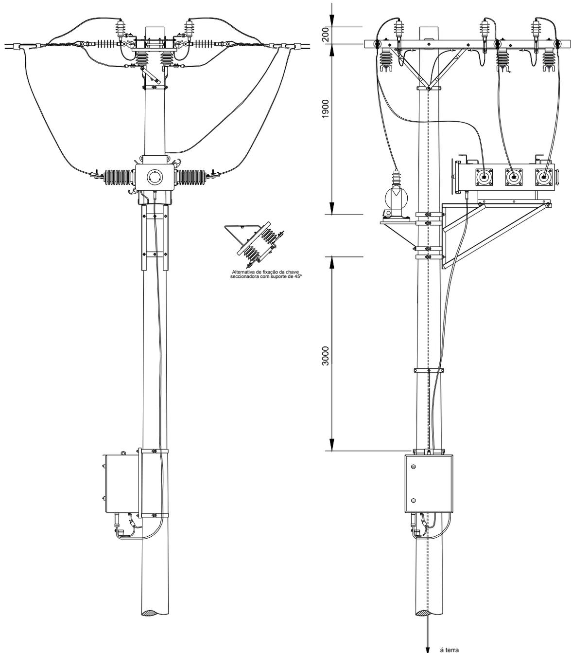
Figura 105 – Instalação de equipamento – Chave seccionadora tripolar
