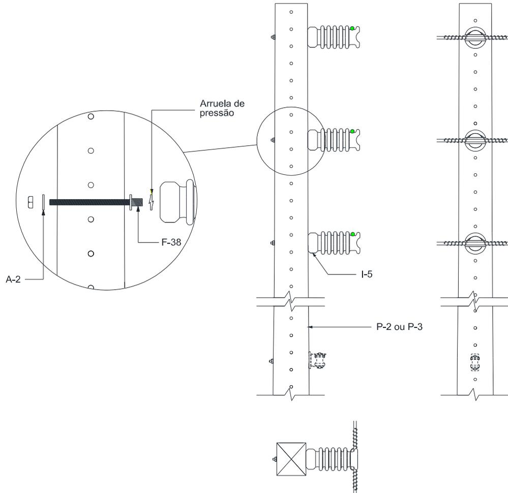
Figura 79 – Estrutura P2 – Poste de seção DT ou madeira
