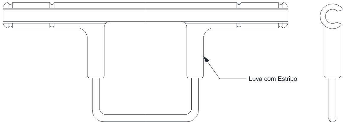
Figura 161 – Conexões – Conector luva estribo
