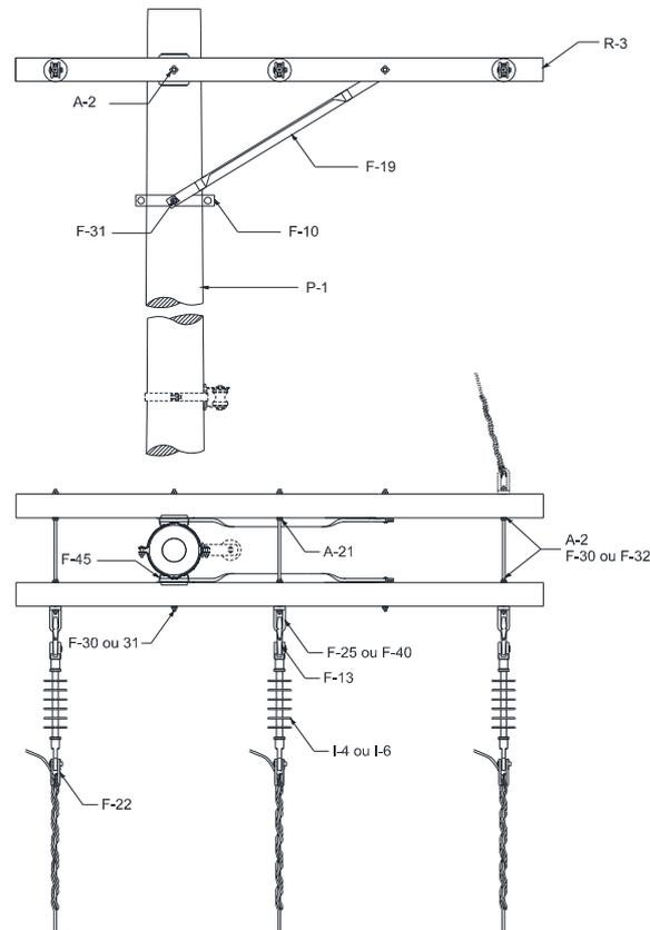
Figura 51 – Estrutura M3 – Poste de Seção Circular
