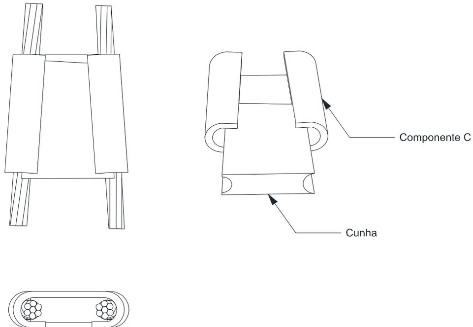
Figura 156 – Conexões – Conector cunha com estribo
