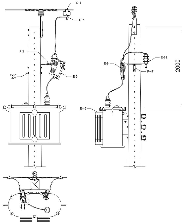
Figura 114 – Instalação de equipamento – Transformador monofásico – Estrutura monofásica
