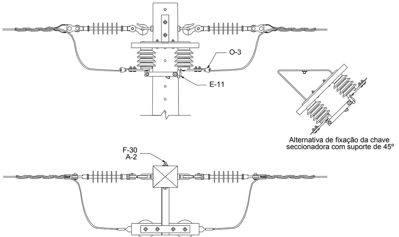
Figura 100 – Instalação de equipamento – Chave seccionadora – Estrutura monofásica
