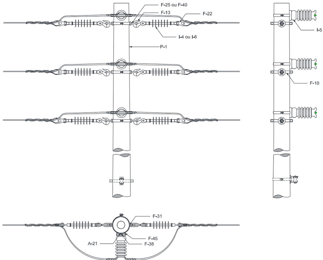
Figura 82 – Estrutura P4 – Poste de Seção Circular
