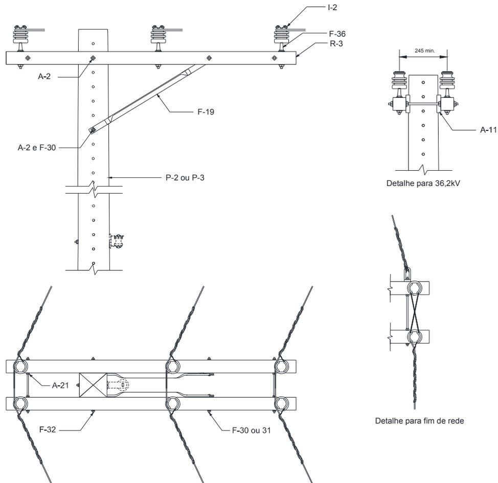
Figura 50 – Estrutura M2 – Poste de seção DT ou de madeira
