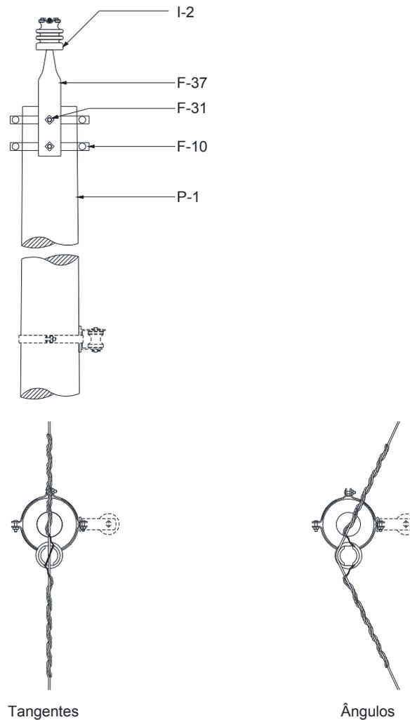
Figura 26 – Estrutura U1 – Poste de Seção Circular
