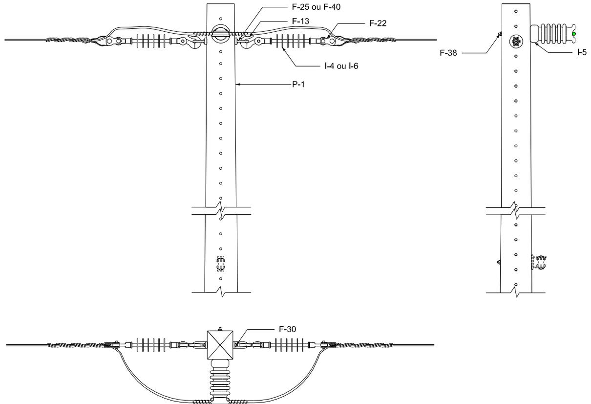
Figura 75 – Estrutura UP4 – Poste de seção DT ou madeira
