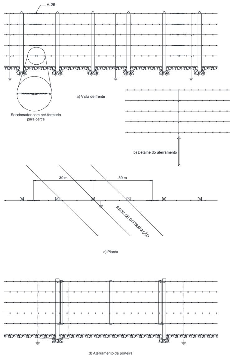
Figura 163 – Seccionamento de cerca – Cerca paralela
