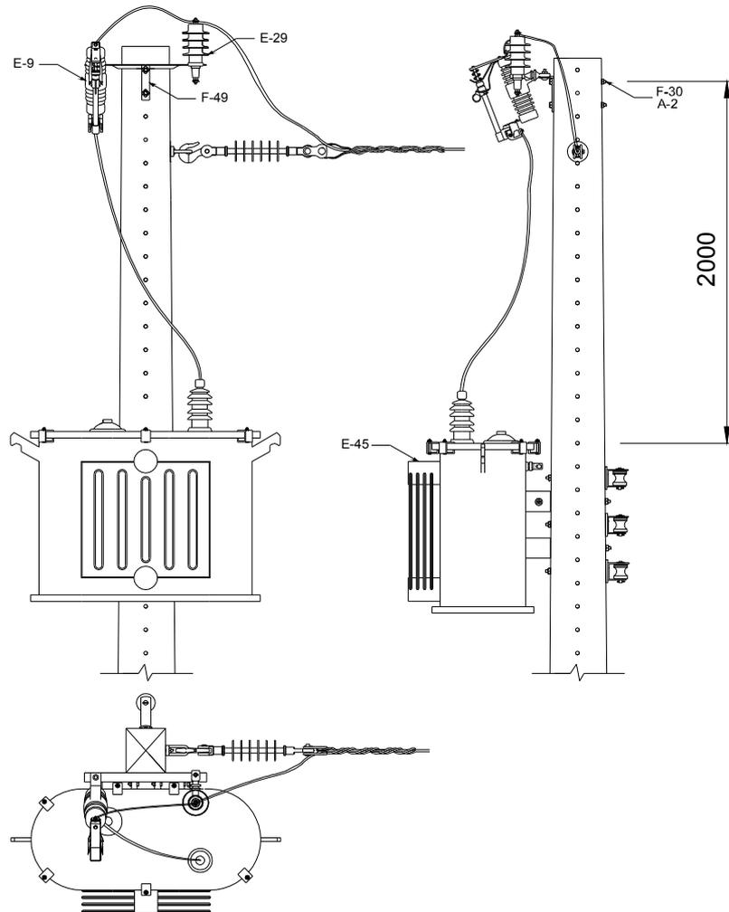
Figura 113 – Instalação de equipamento – Transformador monofásico – Chave-fusível e para-raios no suporte “T” – 1º nível – Estrutura U3
