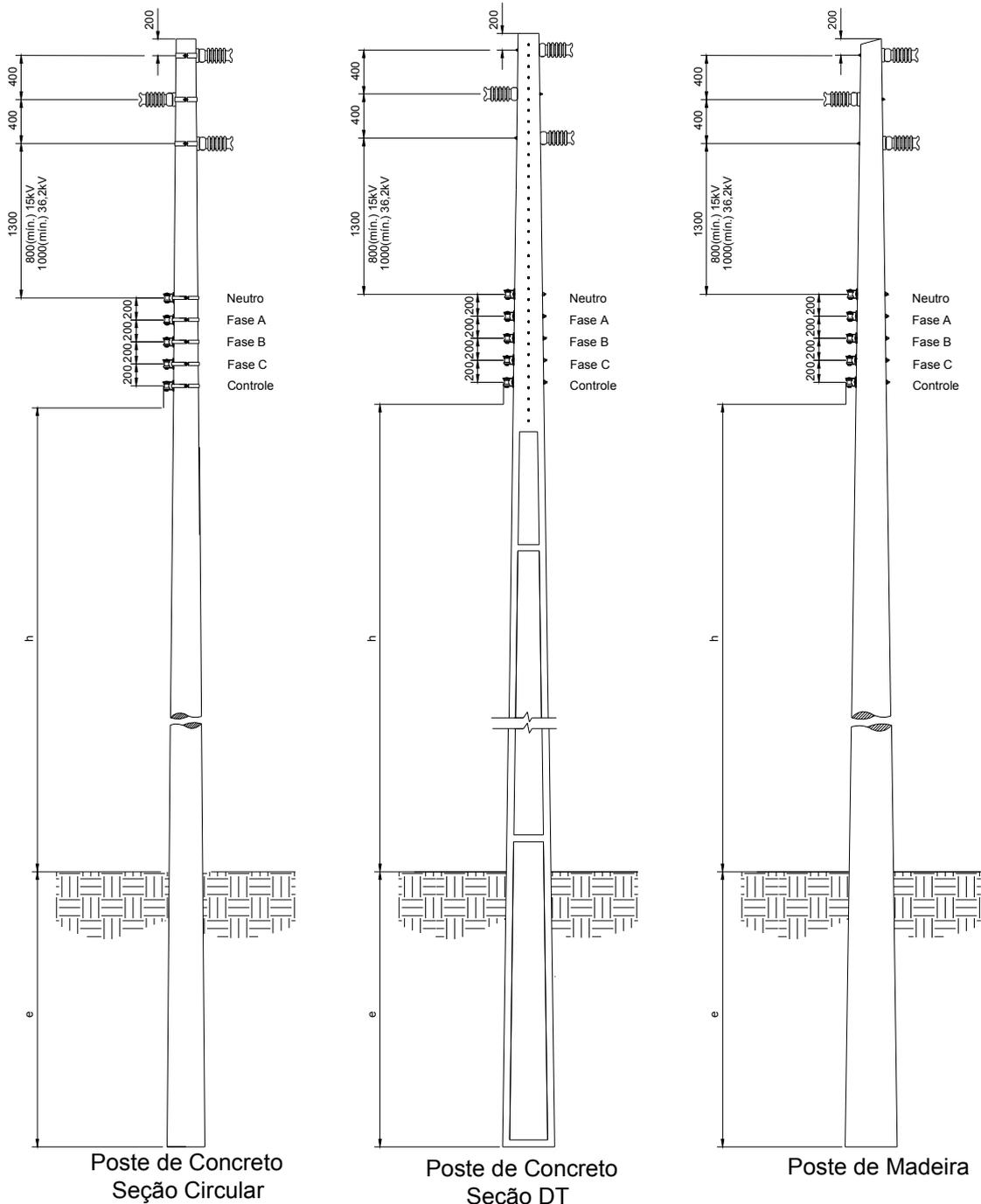
Figura 13 – Afastamentos mínimos – Estrutura pilar trifásica tangente
