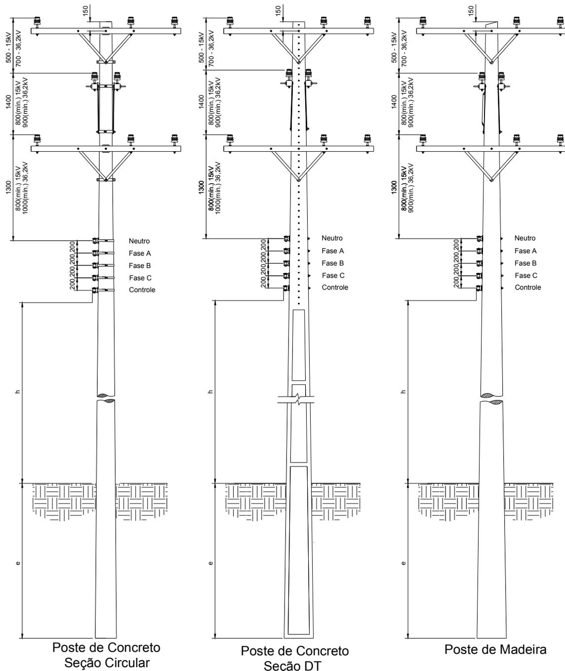
Figura 10 – Afastamentos mínimos – Estruturas trifásicas tangentes e derivação no 1º nível
