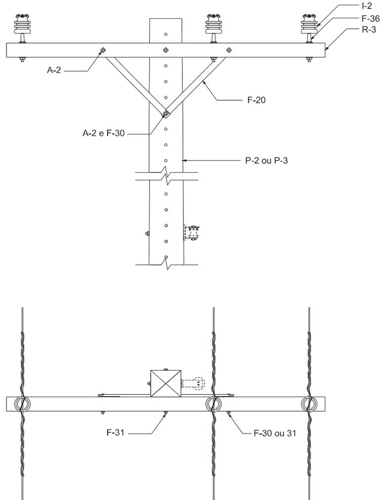
Figura 38 – Estrutura N1 – Poste de seção DT ou de madeira
