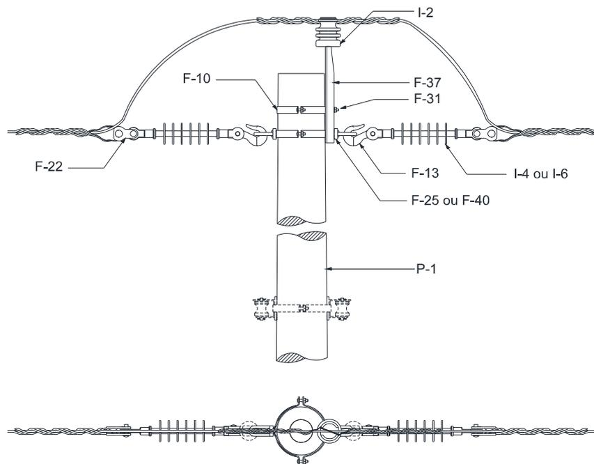
Figura 34 – Estrutura U4 – Poste de Seção Circular
