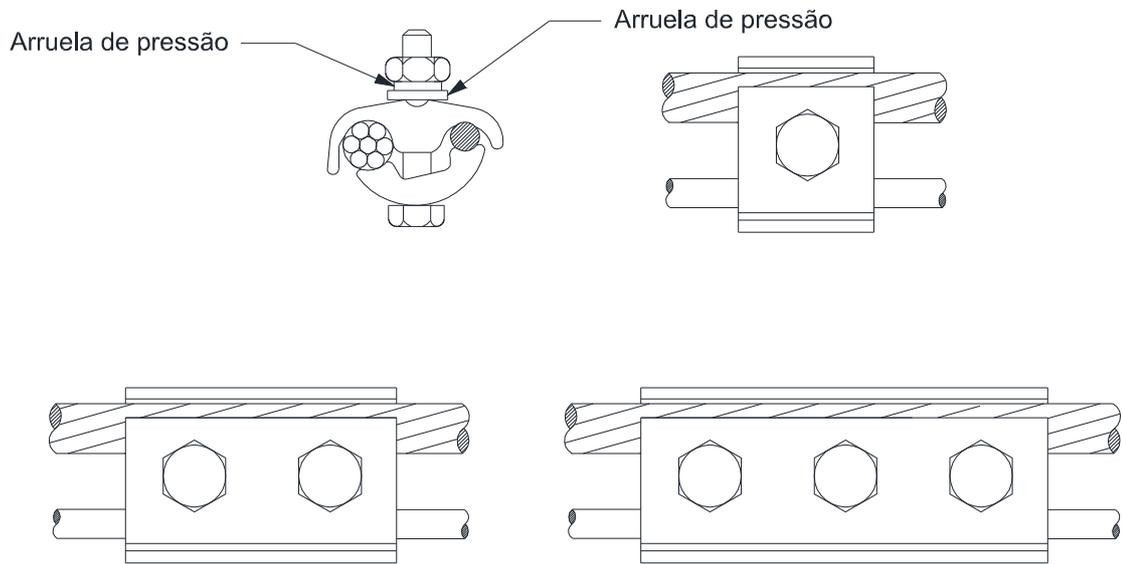
Figura 162 – Conexões – Conector paralelo (1 ou 2 parafusos)
