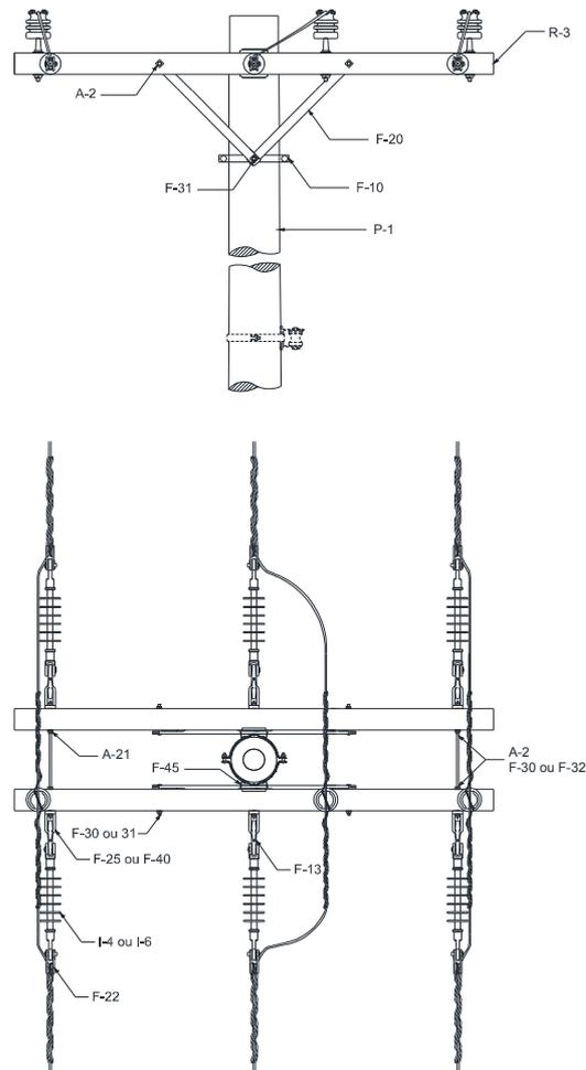
Figura 45 – Estrutura N4 – Poste de Seção Circular
