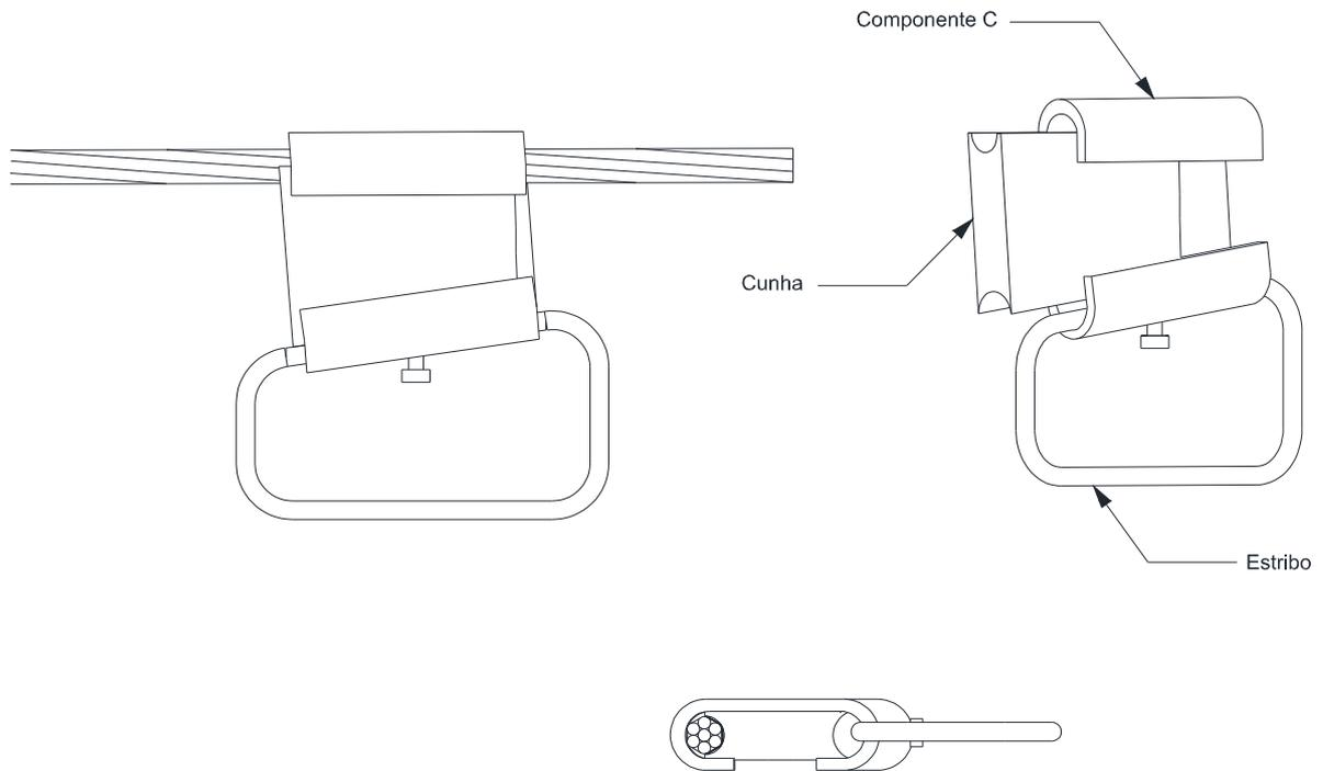
Figura 157 – Conexões – Conector cunha com estribo
