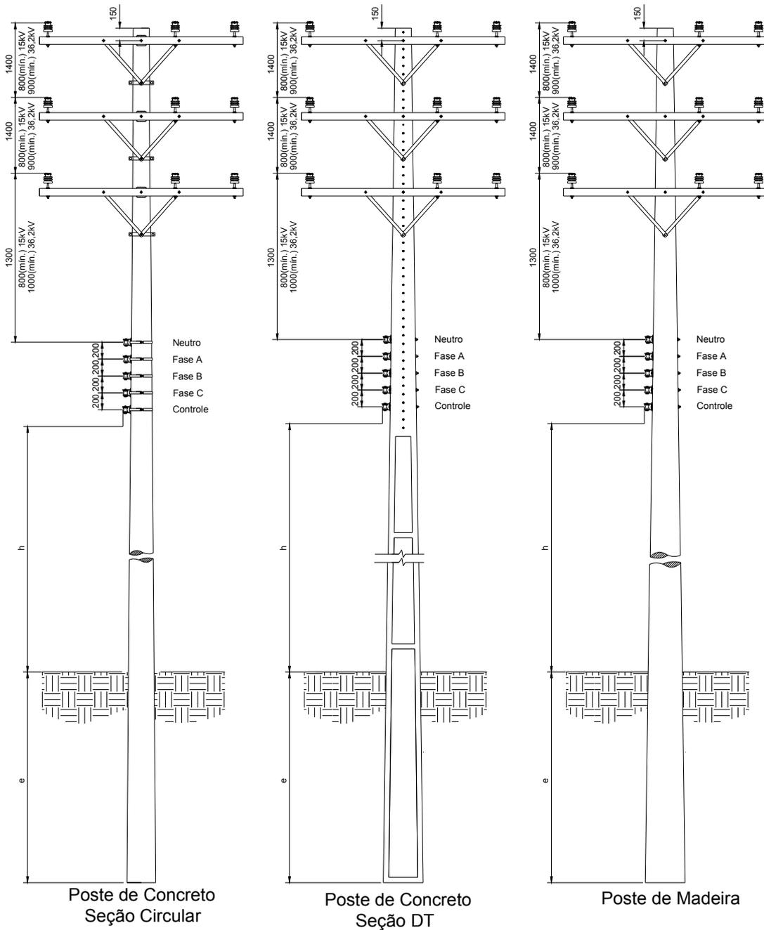
Figura 12 – Afastamentos mínimos – Estruturas trifásicas tangentes
