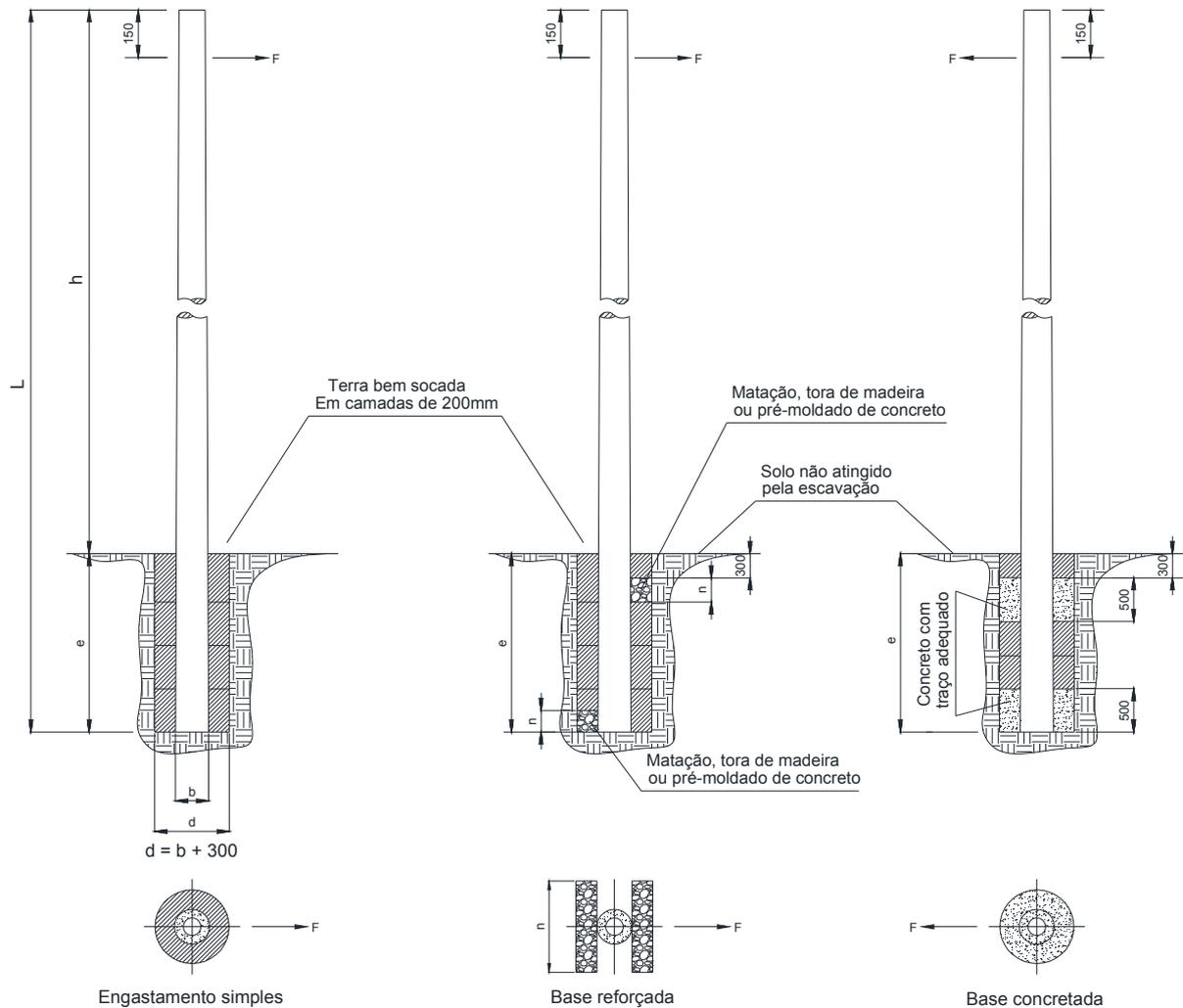
Figura 18 – Engastamento de poste – Detalhe da fundação
