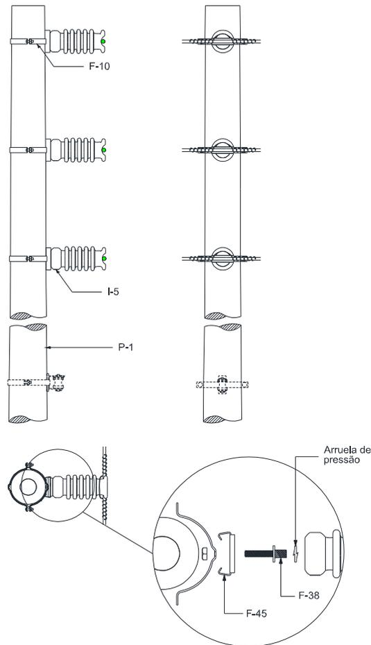
Figura 78 – Estrutura P2 – Poste de Seção Circular
