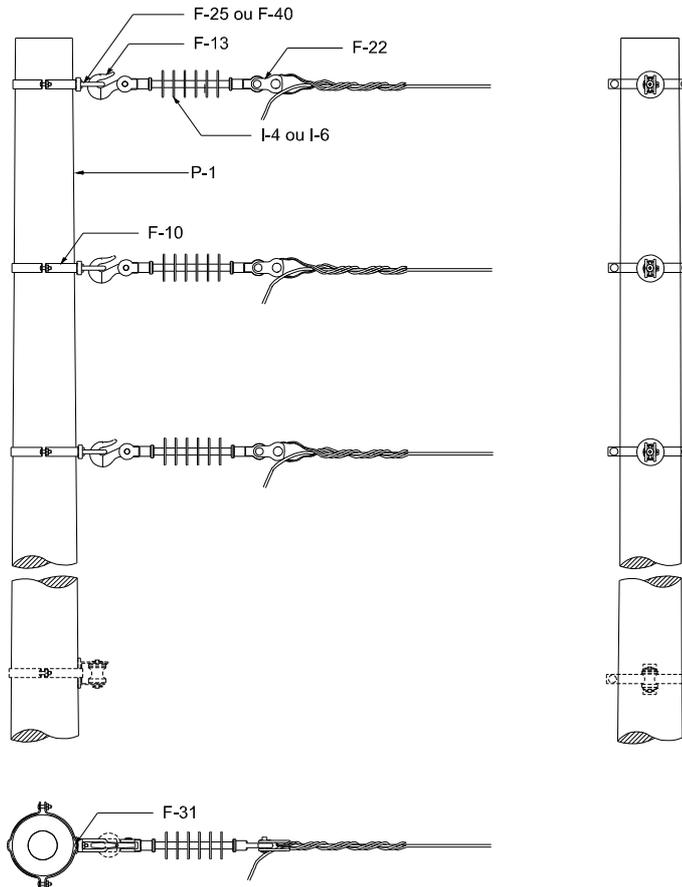
Figura 80 – Estrutura P3 – Poste de Seção Circular
