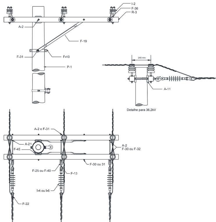
Figura 53 – Estrutura M3-2 – Poste de Seção Circular
