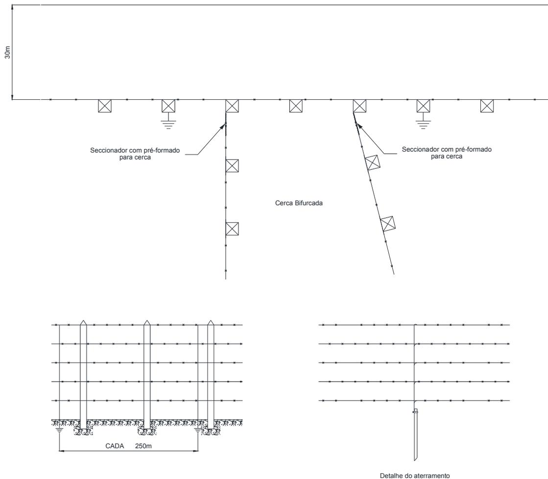
Figura 164 – Seccionamento de cerca – Cercas transversais
