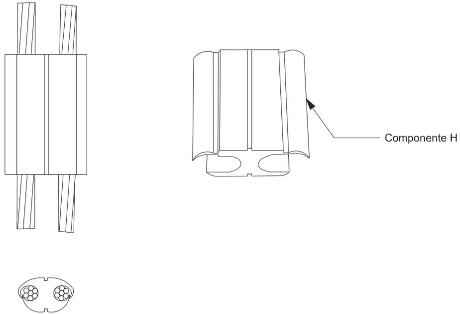
Figura 160 – Conexões – Conector de compressão tipo “H”
