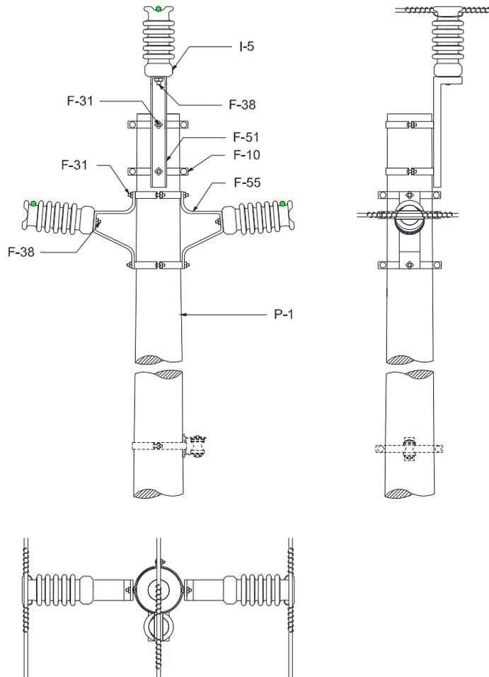
Figura 84 – Estrutura TP – Poste de Seção Circular
