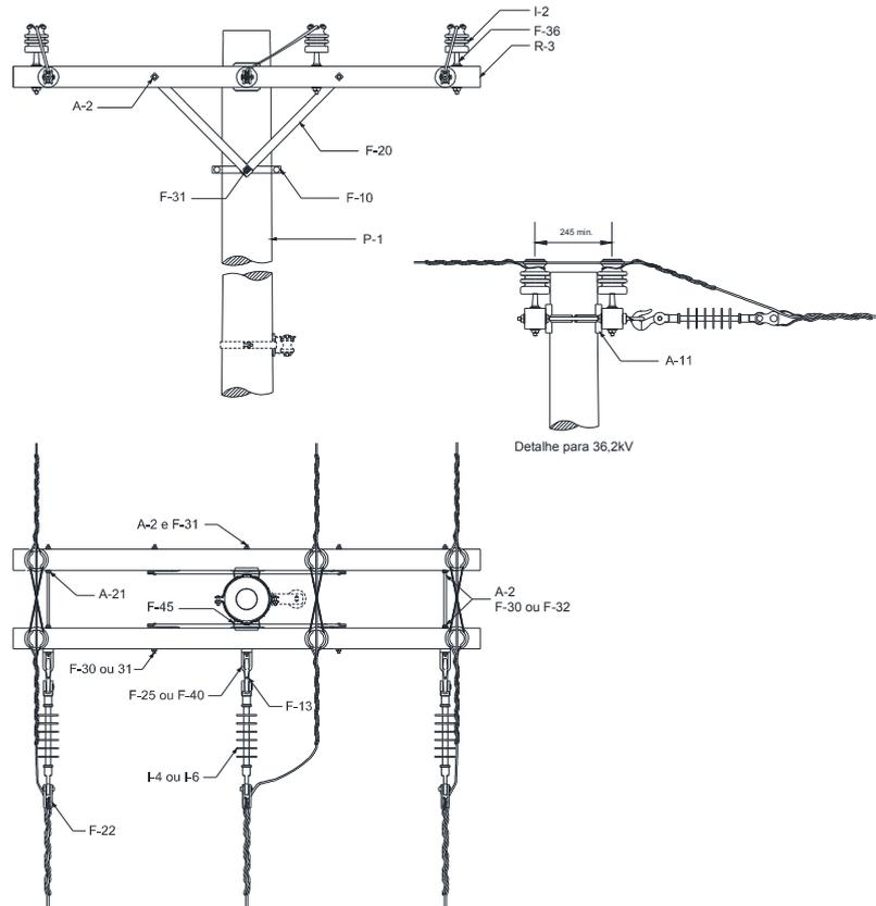
Figura 43 – Estrutura N3-2 – Poste de Seção Circular
