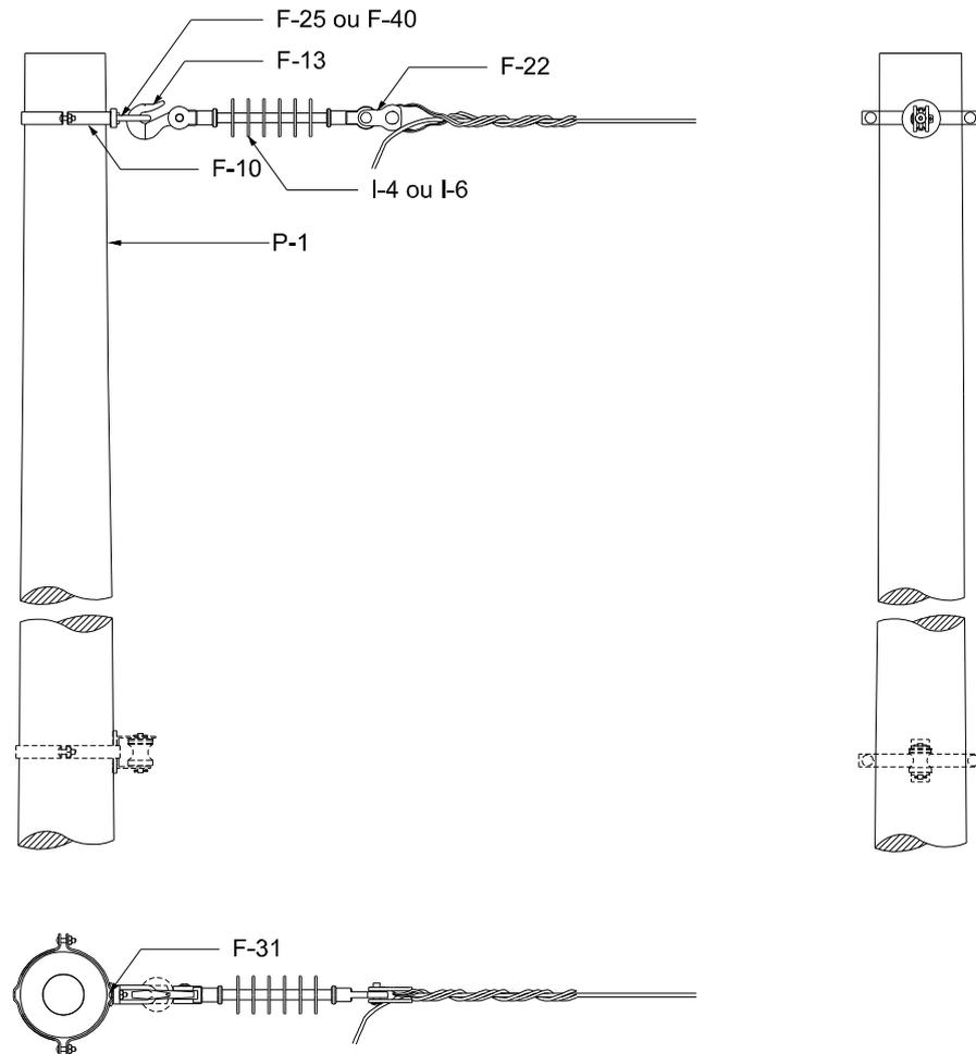
Figura 72 – Estrutura UP3 – Poste de Seção Circular
