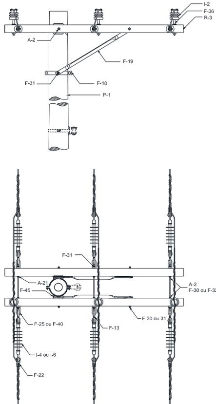
Figura 55 – Estrutura M4 – Poste de Seção Circular
