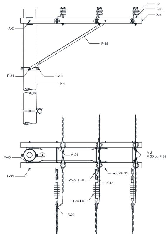
Figura 63 – Estrutura B3-2 – Poste de Seção Circular
