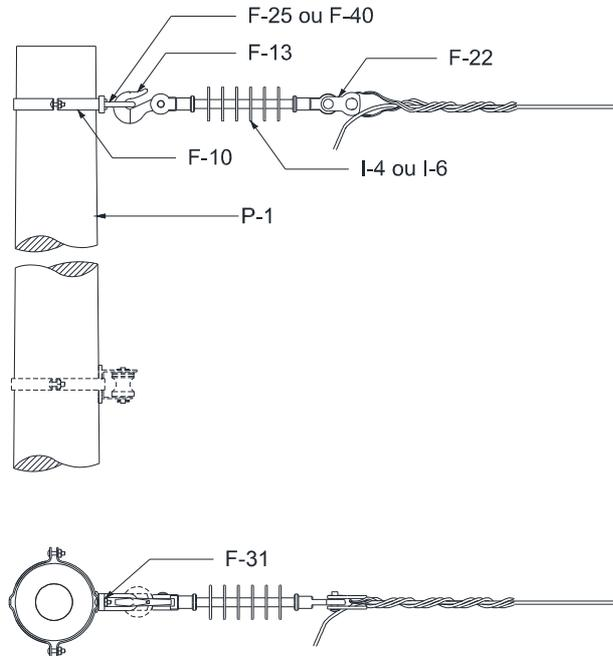
Figura 30 – Estrutura U3 – Poste de Seção Circular
