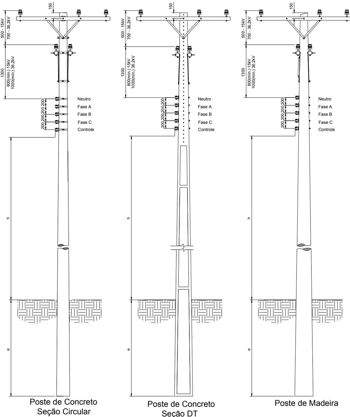
Figura 8 – Afastamentos mínimos – Estruturas trifásicas tangentes com derivações
